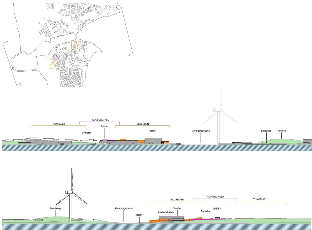
Figur 11-7 Landskabssnit viser, at ny bebyggelse ved Sluseøen – rammeområde 23ce119, vil kunne ses fra Ringkøbing Fjord (øverst illustration) og Vesterhavet (nederste illustration). Bebyggelsen i området er illustreret med orange farve. Øverst ses oversigtskort, der viser hvorfra snit ses. På landskabssnittene oven for er rammeområde 23ce120 angivet som området "Tungevej".
